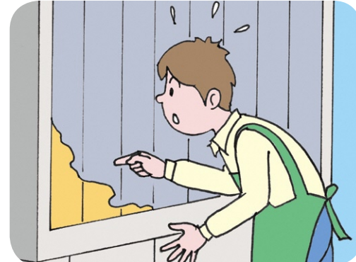
熱交換器の油のにじみ
